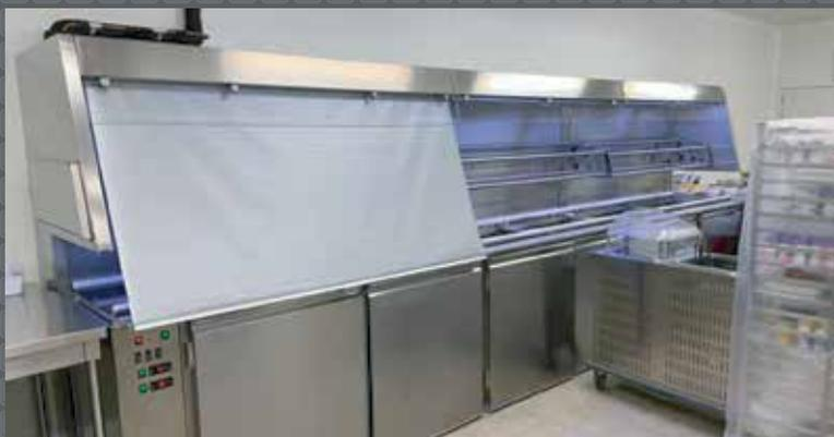
Dans la partie basse de la station de portionnement, les aliments et la vaisselle sont stockés sur des chariots à glissières, dans une température de +4°C
